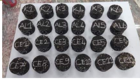
Şekil 1. Marshall tasarımı yöntemi ile elde edilen asfalt betonu numuneleri
